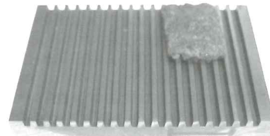
図4 MAGIC砥石による研磨作業
