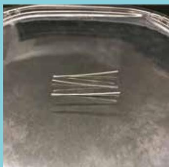
トムソン刃を折りたたんで金属のベースにはめ込むことで、細かいU字型の溝を加工します。溝の幅と長さは自由に設定可能で、最小 0.45mm のU字溝まで加工が可能です。U字型で、かつ幅が狭いので、異物混入等のリスクを低減できます。
