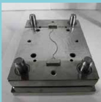
製品の輪郭形状の刃型と、それに沿った打ち抜き溝で切断加工を行い、切断後に微細な溝に彫刻刃先端が入ることによって、当て板やキャリアシートなしで製品を打ち抜くことが可能です。刃先の摩耗や損傷を低減する効果があります。
