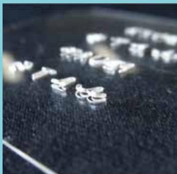
最小サイズ直径 0.5mm、もしくは幅 0.5mm 以上でプラスチック樹脂に極小弁加工を行います。アンカット部を設け、全周抜きをしないことで、スクラップが発生せず、様々な形状での加工が可能です。
