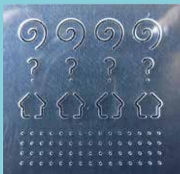
最小サイズ直径 0.5mm、もしくは幅 0.5mm 以上でプラスチック樹脂を貫通穴加工します。加工精度が安定しており、ワイヤー放電加工機を使用して金型を作成するため様々な形状での加工が可能です。
